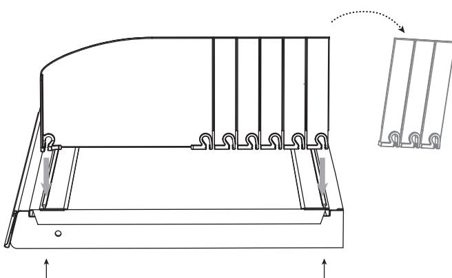
**7** Соберите каркас конструкции. Для этого достаточно установить 4-5 разделителей на Т-профили под углом 90°, как показано на рисунке, поочередно надев каждый разделитель на фиксаторы переднего и заднего Т-профиля сильными плавными движениями сверху вниз.
