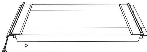
**4** Наклейте передний Т-профиль на полку, удалив защитную полоску от скотча на 4-5 см. Участок профиля с открытым скотчем прижмите сильным движением к полке. Поступательно приклеивайте Т-профиль по всей длине, постепенно отделяя защитную полоску от скотча и плотно прижимая его к полке.
