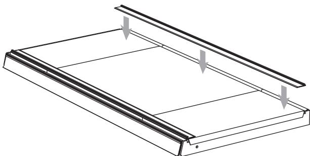
**6** До установки обламывающихся разделителей определите необходимую вам длину разделителя и отломите лишнюю часть конструкции по имеющимся линиям излома.
